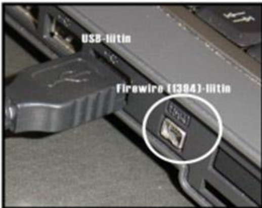
CONECTOR Y CABLE FIREWIRE O IEEE 1394 (dispositivos multimedia)
